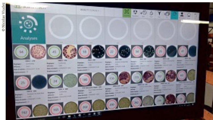
© Nicolas Viudez L'ÉCRAN TACTILE DU SCANSTATION PERMET DE VISUALISER RAPIDEMENT LE RÉSULTAT DES BOÎTES DE PETRI INCUBÉES.
