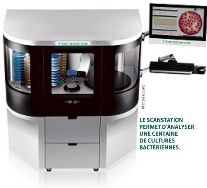
© Nicolas Viudez L'ÉCRAN TACTILE DU SCANSTATION PERMET DE VISUALISER RAPIDEMENT LE RÉSULTAT DES BOÎTES DE PETRI INCUBÉES.
