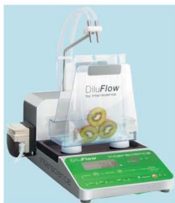
Dilueurs gravimétriques . Les appareils intègrent jusqu'à six diluants.
