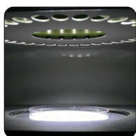
Dark Field : les LED sont disposées en cercle pour un contraste optimal
