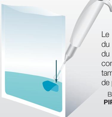
Le pipetage en partie basse du sac offre un prélèvement du filtrat sans risques de contamination croisée notamment pour la recherche de pathogènes sous PSM.
