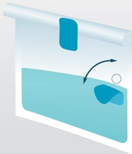
La recherche des indicateurs de qualité et des pathogènes conduit à des pipetages successifs. La zone de pipetage permet de réduire l'action d'ouvrir/fermer le sac.
