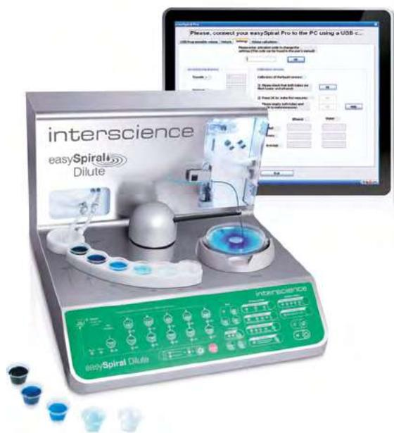
easy**Spiral** Dilute es un diluidor y sembrador automático en placas de Petri. Permite hacer diluciones seriadas de 1/10 y siembras hasta de 6 log. en una sola placa de Petri. Para una muestra de bacterias de 30 hasta  $1 \times 10^{12}$ , no hay necesidad de hacer diluciones manuales y la siembra es automática.
