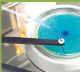
Inocular la cepa para ser analizada con el easySpiral en modo "Constante" y colocar los discos de antibióticos antes de la incubación.
