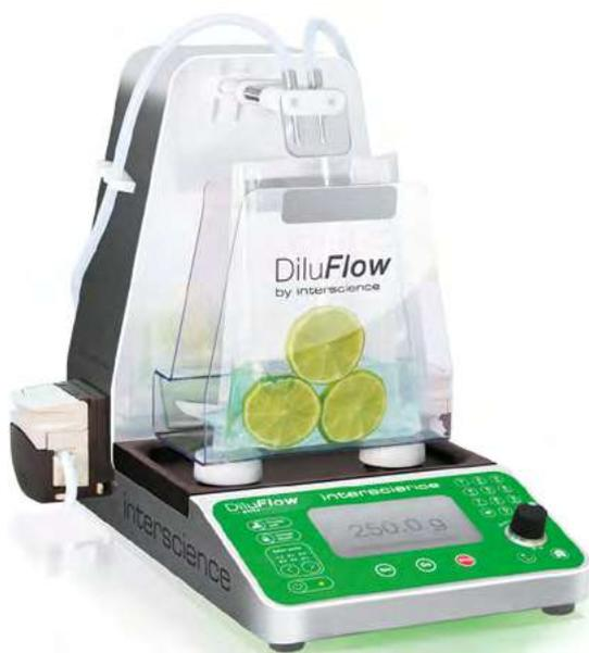
DiluFlow Elite 5 kg diluye automáticamente y en segundos una muestra sólida con la masa apropiada de diluyente hasta un peso total de 5 kg. Su trazabilidad completa permite registrar todas las operaciones realizadas. Es programable y conectable con hasta 6 diluyentes, lo que ofrece la mejor solución para diluciones de cualquier tipo de muestra.
