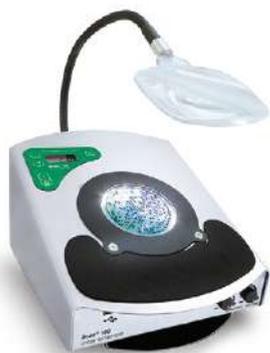
**Scan® 100** permet le comptage précis des colonies sur tous types de supports. Le port USB intégré permet d'exporter les résultats pour garantir la traçabilité.
