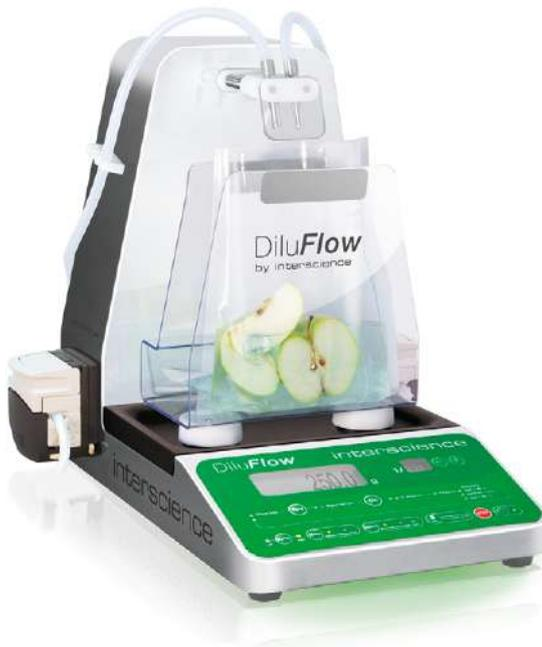
DiluFlow® Pro dilue automatiquement un échantillon solide avec la masse appropriée de diluant jusqu'à un poids total de 5 kg. Son bras robotisé facilite l'insertion de l'échantillon dans le sac et le travail sous PSM.
