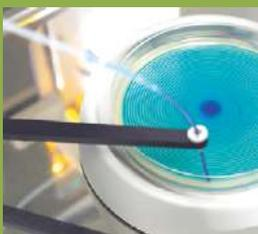
Inoculer en mode constant la souche à analyser avec easySpiral® et poser les disques d'antibiotiques. Placer la boîte dans un incubateur.
