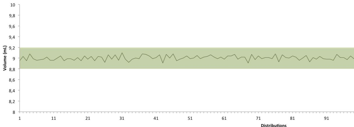
Les résultats obtenus sont listés et représentés sur un graphique. Sur ce graphique, en plus d'avoir la courbe des résultats, est donné l'intervalle d'erreur accepté de  $\pm 0,2$  mL, conformément aux recommandations de la norme ISO 6887-1, dans sa partie « préparation des dilutions décimales »
