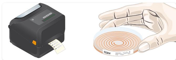
Imprimer l'étiquette avec le code Datamatrix. Coller l'étiquette sur la boîte de Petriensemencée à placer en incubation.
