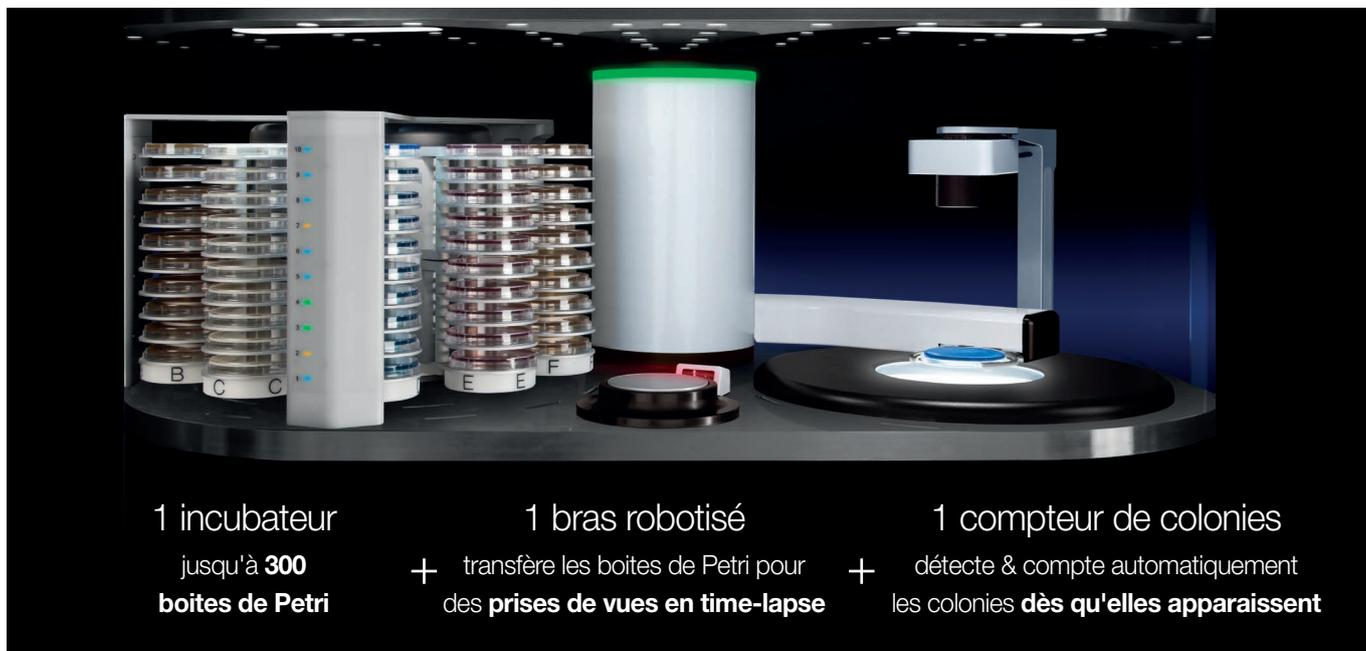
ScanStation® est une station d'incubation et de comptage en temps réel qui centralise **incubation, détection et comptage jusqu'à 300 boîtes de Petri** simultanément. Durant le processus, les boîtes de Petri sont comptées toutes les 30 min\*. **Les colonies sont détectées dès leur apparition.** Exemple ci-dessous : *Coliformes* sur gélose VRBL incubé à 37 °C
