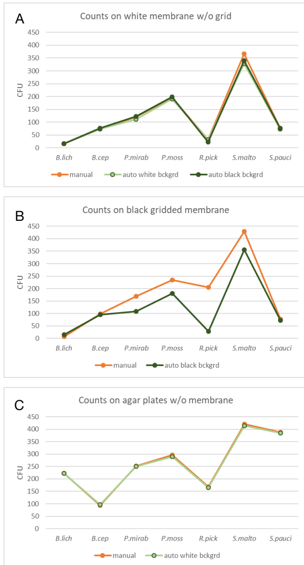
Figure 1 Comptage des UFC de 7 souches bactériennes sur différents types de membranes (A : membrane noire quadrillée, B : membrane blanche non quadrillée) et sur une boîte de gélose sans membrane (C). Les lignes orange correspondent aux comptages manuels sur boîtes ("référence") et les lignes vertes aux comptages automatiques effectués par ScanStation®. Pour les comptages automatiques, deux configurations de lumière pour prendre des photos ont été testées : black bckgrd (fond noir) et white bckgrd (fond blanc). Liste des bactéries testées= B.lich : Bacillus licheniformis , B.cep : Burkholderia cepacian , P.mirab : Proteus mirabilis , P.moss : Pseudomonas mosselii , R.pick : Ralstonia pickettii , S.malto : Stenotrophomonas maltophilia , S.pauci : Sphingomonas paucimobilis .
